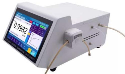
**Принцип измерения:** небольшое количество образца вводится в пробирку с контролируемой температурой, регистрируется частота или период колебаний и рассчитывается плотность образца с использованием заранее полученной константы пробирки. Константа пробирки определяется частотой колебаний при заполнении пробирки калибровочной жидкостью известной плотности. Значения плотности отображаются сразу после введения образца в пробирку.
