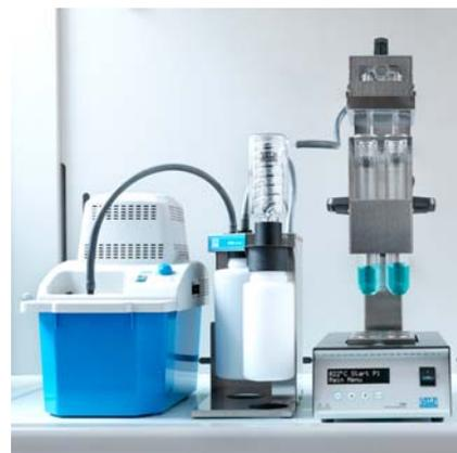
Рекомендуется устанавливать систему дигестор-скруббер-насос в вытяжной шкаф, чтобы оградить персонал лаборатории от неприятных запахов, возникающих в процессе термического разложения пробы и предотвратить попадание остаточных кислотных паров в помещение. Вытяжной шкаф должен быть оснащен системой подводки холодной воды с лабораторным краном, снабженным наконечником для присоединения тонких резиновых шлангов и дренажной кюветой, присоединенной к системе канализации.
