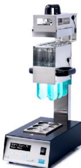
DK 6/48 6 пробирок V= 300 мл - Ø 48 мм
