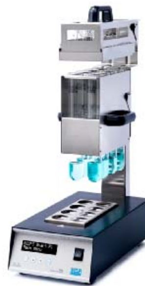
DK-8 8 пробирок V=250 мл, Ø 42 мм.
