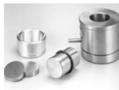
Вакуумный набор пресс-форм (извлекаемых матриц) для формирования дисков. В комплект входят корпус экструзионной головки, основание, поршень, две полированные стальные таблетки диаметром 13 мм, вакуумные уплотнительные кольца и выбивное кольцо для извлечения пробоотборного диска.
