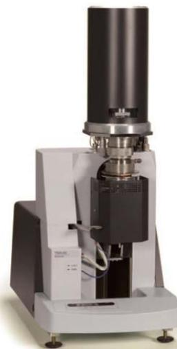
С помощью ТМА-60 можно выполнять три типа измерений: измерение натяжения, измерение расширения и измерение пенетрации. Благодаря байонетному соединению в конструкции держателя образца и встроенному датчику температуры очень легко осуществлять не только переключение между режимами измерения, но и ремонт, если это необходимо.
