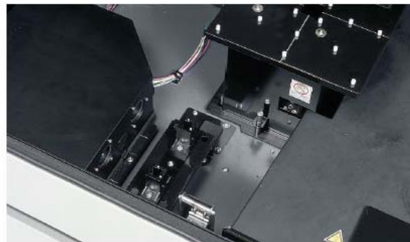
Измерение жидких проб с помощью блока DDU
