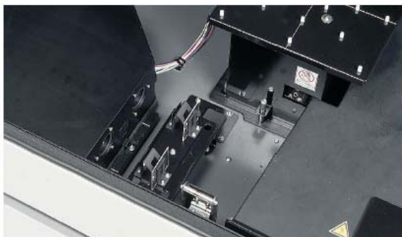
Измерение образцов пленок с помощью блока DDU
