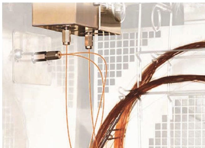
Рис.8. Подсоединение двух колонок различного типа к интерфейсу масс-селективного детектора
