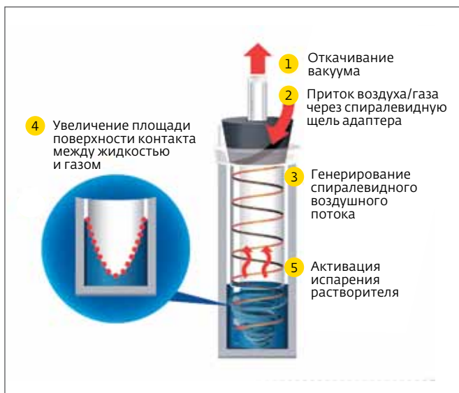
Рис.3. Принцип работы Smart Evaporator C1 компании Bio-Chromato (Япония)
