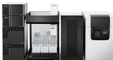
Если целевое соединение не поглощает свет или если примеси в растворе образца не поглощают свет, эффективность препаративной очистки можно повысить, также используя детектор, не основанный на принципе поглощения света, такой как ELSD (испарительное рассеяние света). Детектор) или МС (масс-спектрометр). В частности, фракционирование с использованием триггера МС может использовать высокую
