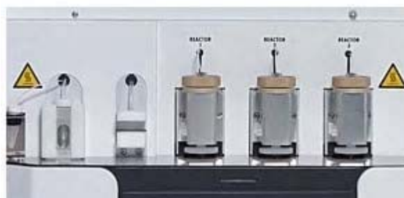
PPSQ-53A Тройной реактор Поддерживает последовательный анализ 3 проб. Использование тройного реактора позволяет сэкономить время и усилия, а также дает большую свободу при составлении программ анализа.
