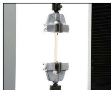
Плоские захваты винтового типа
