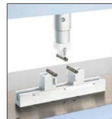
Испытание на 3-точечный изгиб образца из пластика
