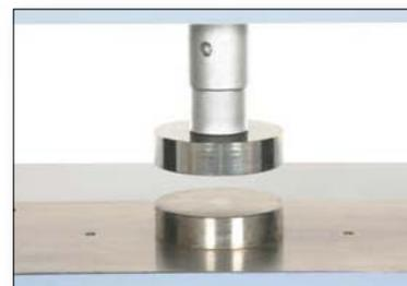
Компрессионные плиты фиксированного типа
