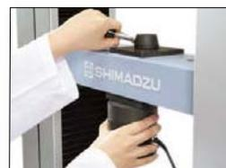
Прикрепление/снятие датчика нагрузки (тип 10 кН)
