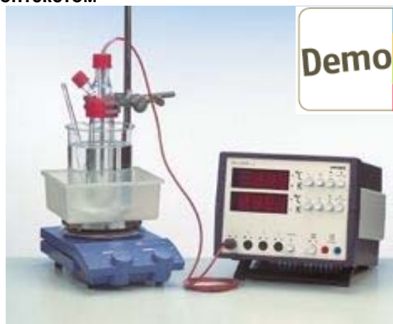
Количественный эксперимент: Определение молярных масс путем измерения повышения температуры кипения (эбуллиоскопия) (P1136000)
