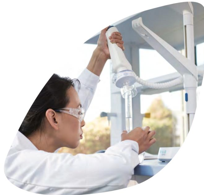
В режиме **Волюметрического дозирования** система способна самостоятельно наполнять Вашу лабораторную посуду до необходимого объема, не отрывая Вас от других лабораторных задач. Подача воды будет автоматически прекращена при достижении заданного объема.
