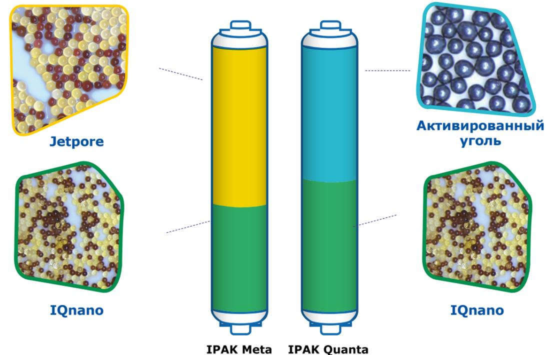
Использование высококачественного синтетического активированного угля в картридже ИПАК-Quanta® также позволяет улавливать следовые количества органических загрязнителей после окисления встроенной в систему Milli-Q® IQ 7000 лампы фотоокисления. Эта уникальная, не содержащая ртути, изготовленная по технологии esch<sub>2</sub>o УФ-лампа обеспечивает окисление органических загрязнителей за счет использования технологии с эксимером (возбужденным димером) ксенона, излучающим на длине волны 172 нм.
