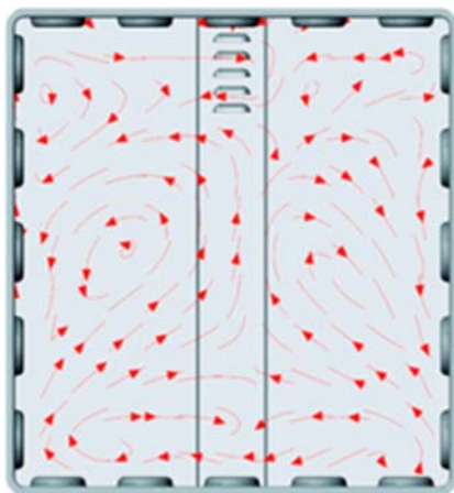
Воздушный поток в нагревательной камере в моделях с естественной конвекцией
