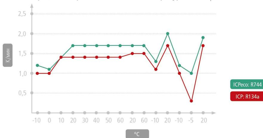
В среднем на 20% более высокая скорость изменения температуры при использовании компрессора, охлаждаемого CO<sub>2</sub> (измерение ICP260eco при температуре окружающей среды +22°C согласно IEC 60068-3-5)
