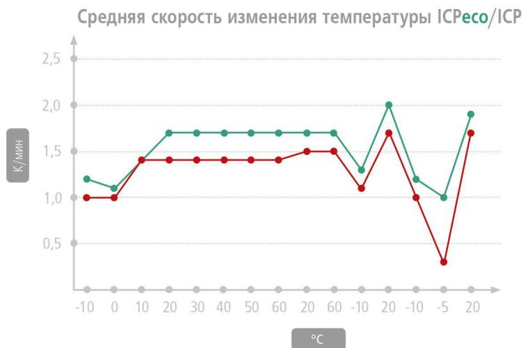
В среднем на 20% более высокая скорость изменения температуры при использовании компрессора, охлаждаемого CO<sub>2</sub> (измерение ICP260eco при температуре окружающей среды +22°C согласно IEC 60068-3-5)
