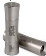
Кварцевая контрольная пластина поляриметра PQP
