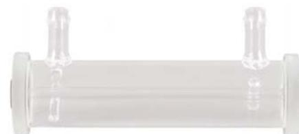
Стекломерная измерительная трубка для поляриметра PRG-100-DT
