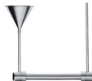
Измерительная трубка из нержавеющей стали для поляриметра PRM-100-D
