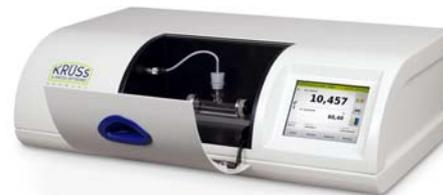
Поляриметр P8000 с измерительной трубкой PRG-100-E и датчиком температуры PRT-E
