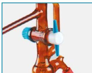
*Все автоматические бюретки оснащены промежуточным краном из PTFE, обеспечивающим надежное, быстрое и точное измерение.*
