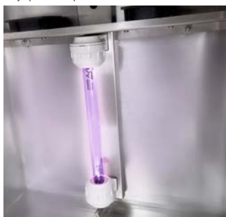
Система УФ-рециркуляции воздуха внутри камеры
