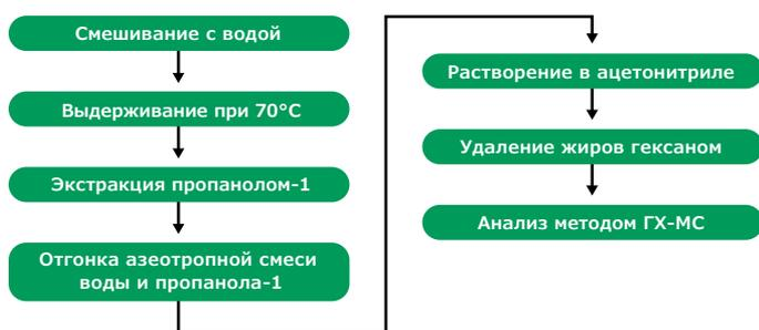
**Рисунок 40. Определение акриламидов методом ГХ-МС**
