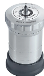
AOD 1.1 Сосуд для разложения со стационарным запальным проводом
